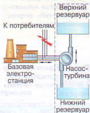
Схема гидроаккумулирующей электростанции
